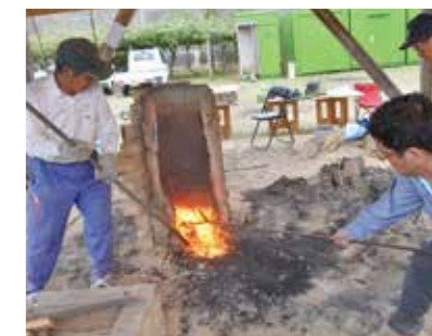
炉を壊し鉄（ケラ）を取り出す
