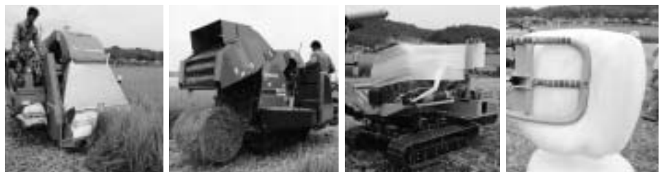
①刈り取りながら、わらに乳酸菌を混ぜる ②きざんだわらを圧縮して、円柱の形にする ③ビニールでラッピングする ④稲発酵粗飼料の完成
