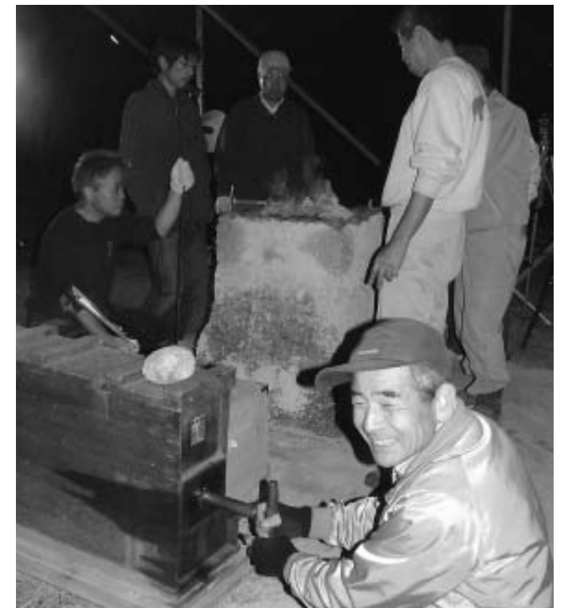
フイゴ（手前）から炉に送風。地元でとれた釜土や炭を使い遺跡の炉を復元した
