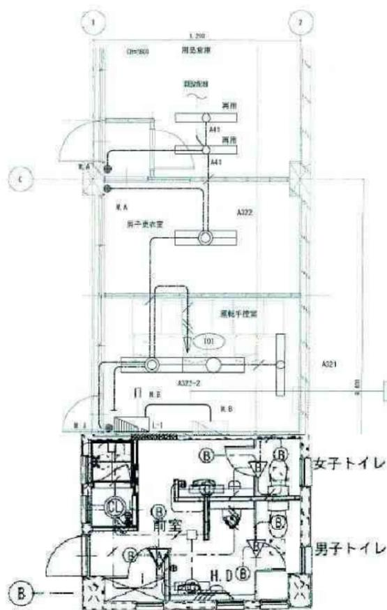
改修後 1階浴室・運転手控室電灯設備平面図 S=1:100
