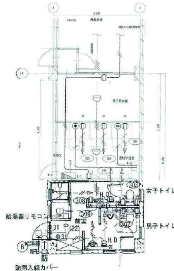
改修後 1階浴室・運転手控室コンセント・弱電設備平面図 S=1:100
