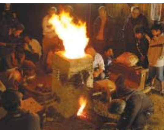
参加事業の「6世紀の古代のたたら操業Ⅱ」。岩手県金石産の鉄鉱石を使って約11kgのケラ(鉄)を作ること成功
