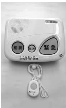
緊急通報装置
