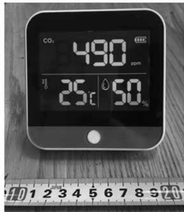
CO 2 濃度測定器 アメリカではCO 2 濃度が700ppmを超えると感染リスクが高くなると言われている。夏に窓を閉め切ったエアコンを使用するとCO 2 濃度が高くなる。換気のタイミングを計る目安として期待できる。
