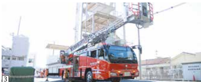
③ 令和 2 年 10 月に導入された最新のはしご付消防自動車。はしごの先端屈折や自動収納、揺れを制御する装置などを備えている
